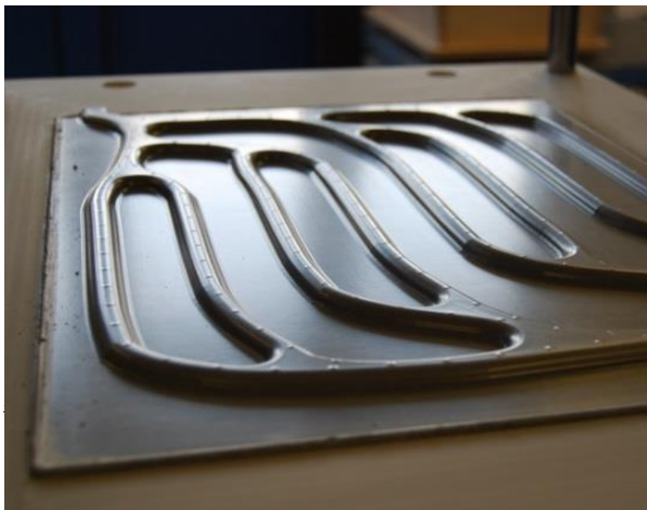
TABSOLAR-Element aus Ultrahochleistungsbeton (UHPC), das im Membran-Vakuumtiefziehverfahren hergestellt wurde. ©G.tecz Engineering GmbH
