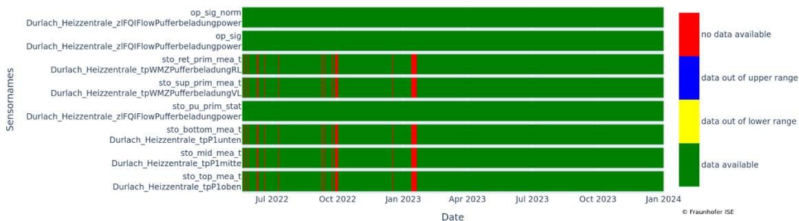
**Abb. C5-4: Heizzentrale – Wärmespeicher: Datenqualität.** Den jeweiligen Datenpunkten (Y-Achse) wird zu jedem Zeitschritt (X-Achse) ein Farbcodierung zugewiesen, welcher der Qualität der Eingangsdaten entspricht (Rot: Fehlende Daten, Blau: Werte oberhalb des gültigen Wertebereichs, Gelb: unterhalb des gültigen Wertebereichs, Grün: Valider Wert). Bis auf kleinere Zeitbereiche von maximal einer Woche liefern die genutzten Datenpunkte eine hinreichende Datenqualität.
