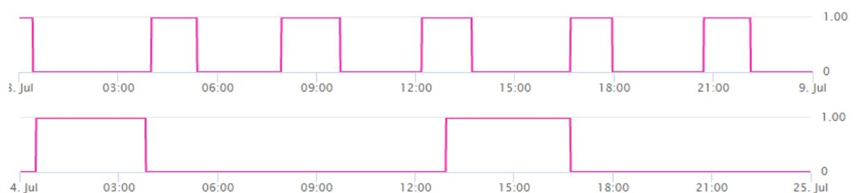
**Abb. C4-1: Betrieb BHKW. oben: bisherige Regelung. unten: neu implementierte Regelung**
