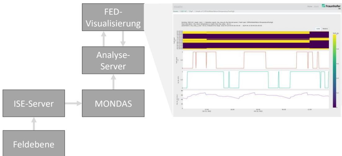
**Abb. C5-1: Datenfluss in der Anwendung der Fehlererkennung:** Die im Monitoring aufgezeichneten Messdaten werden in der MONDAS Monitoringplattform aufgezeichnet. Diese fungiert als Datenbank und übernimmt eine grundlegende Datenvorverarbeitung und -bereinigung. Zur Fehlererkennung und Diagnose (FED) werden die Daten auf einen Analyse-Server übertragen. Die Analyseergebnisse werden zur Visualisierung in eine Web-App übertragen (hier beispielhaft dargestellt).
