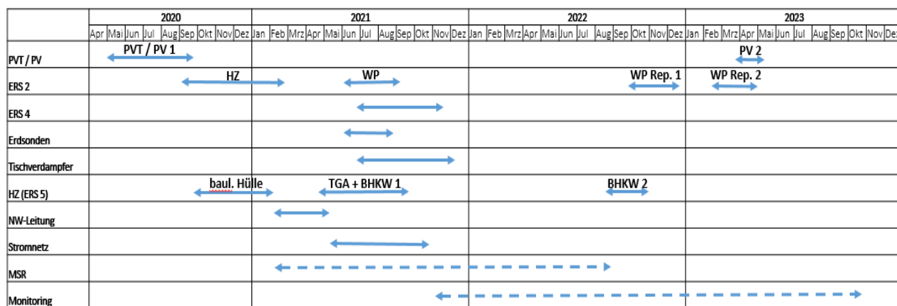
Abb. B1-8: Tatsächlicher Zeitbedarf zur Errichtung der einzelnen Komponenten des Energiesystems „SQ Durlach“ (ohne Planungsvorlaufzeiten (zu vergleichen mit dem ursprünglichen Zeitplan, Abb. B1-1).
