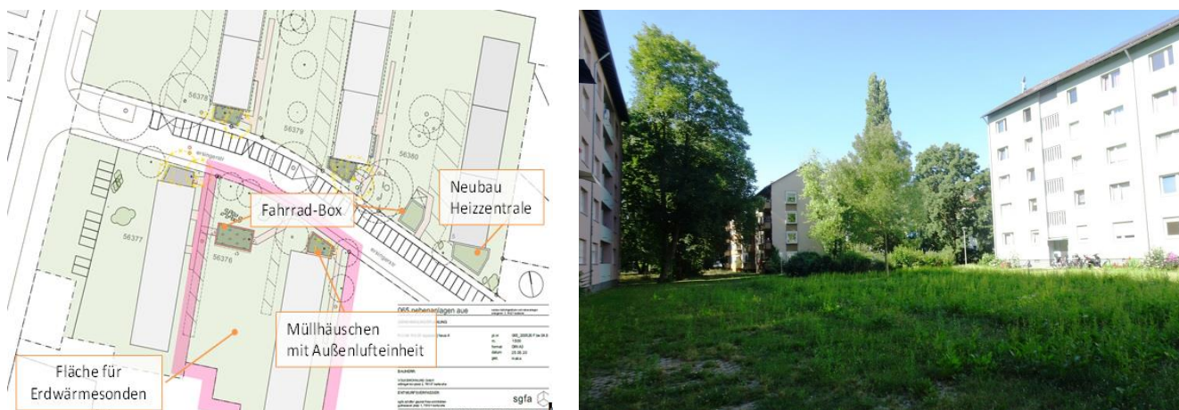
Abb. B1-3: Links: Außenanlagen des Energiesystems. Die Trafo-Station (nicht im Plan eingezeichnet) befindet sich zwischen Ersinger Straße 5 (Heizzentrale) und Ersinger Straße 3. rechts: Fläche zwischen den Gebäuden Ersinger Straße 2 und 4, unter der die 18 Erdsonden mit je 18 m Länge eingebracht wurden (Aufnahmezeitpunkt: 6 Monate nach Überdeckung des Erdsonden-Feldes).
