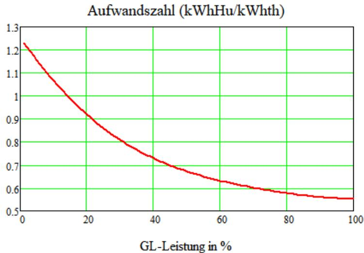
**Abb. Anh. A-9:** Aufwandszahl (= Gaseinsatz pro erzeugter Nutzwärme) des Systems ‚BHKW-Wärmepumpe‘ plus *Spitzenlastkessel* als Funktion der GL-Auslegung (0 bis 100 %).
