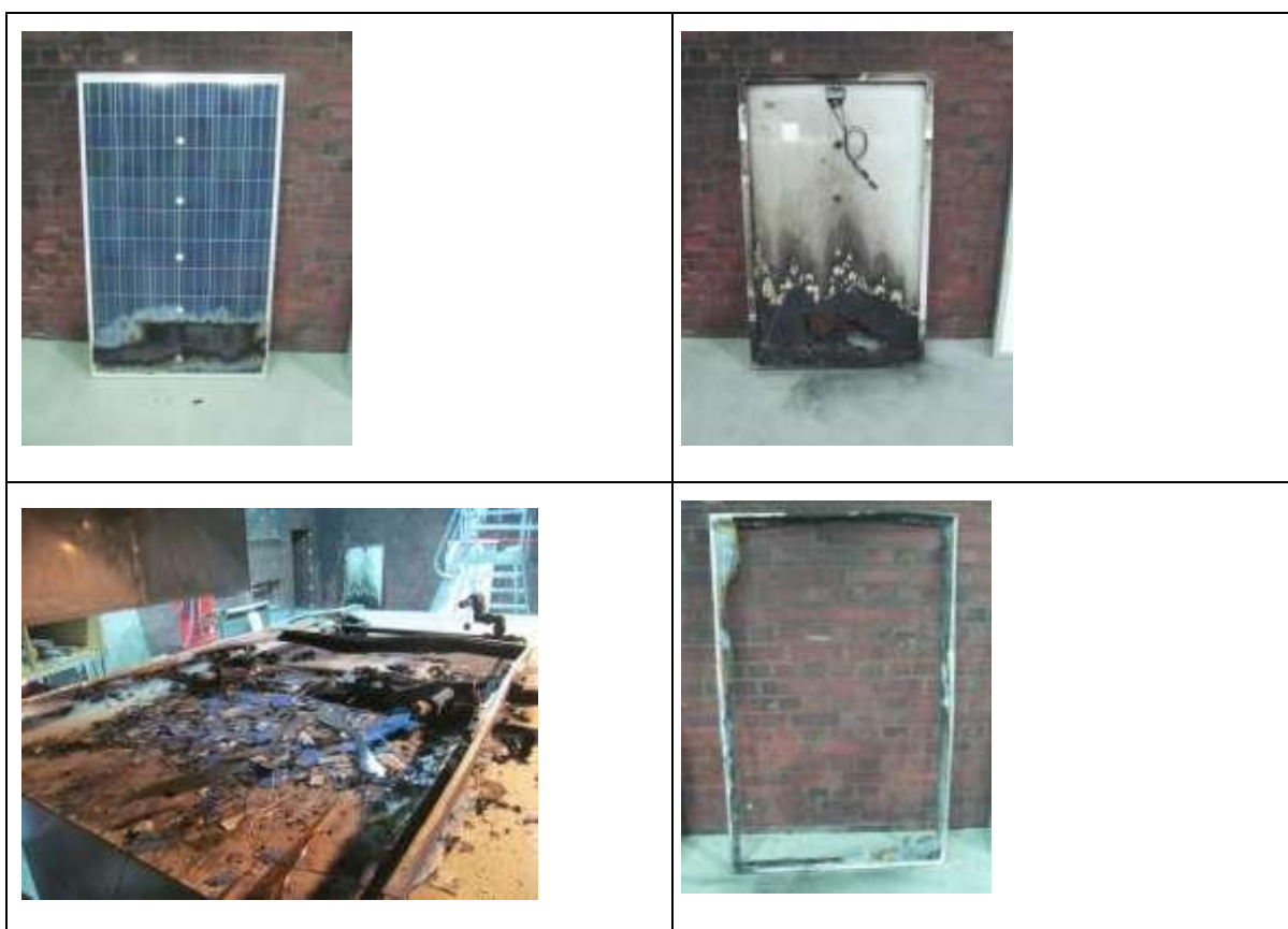
Figura 4-37: Extensión del daño en c-Si con quemador de 25 kW (arriba) y de 150 kW (abajo)
