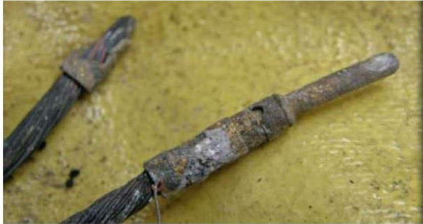
Figura 3-21: Restos de dos conectores sacados de los escombros de un edificio, [9] (Foto: Instituto para la Prevención e Investigación de Daños (IFS de acuerdo a sus siglas en alemán).
