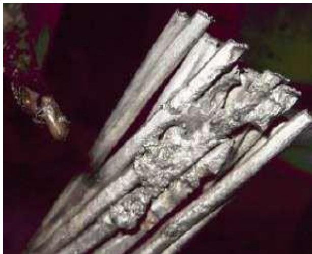
Figura 3-29: El extremo de un conductor de aluminio (Foto: Uli Motzer, compañía de seguros de Würtemberg)
