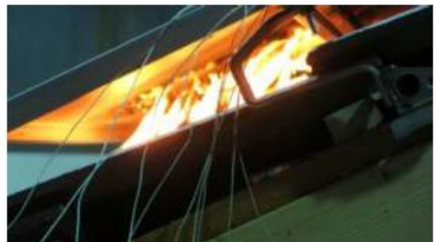
Figura 5-31: Izquierda: Estructura de techo paralelo con tejas de cemento y módulo FV. Derecha: El iniciador de ignición se ubicó entre el módulo y la superficie del techo
