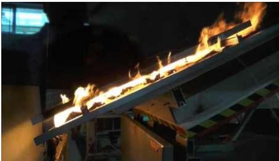
Figura 3: Prueba de incendio con una potencia de 25 kW (arriba) y 150 kW (abajo)
