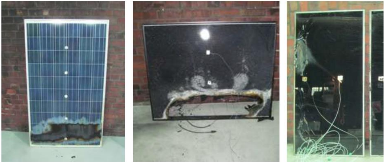
Figura 3-2: Daños después de una solicitud con 25 kW de potencia del quemador, a la izquierda, c-Si, al centro, CIS (puesto en sentido transversal) y a la derecha, CdTe (puesto en sentido transversal).
