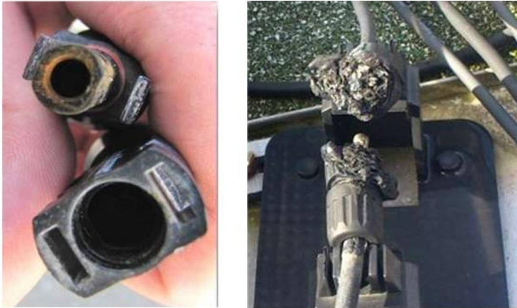
Figura 3-48: Resultado del acoplamiento de conectores de diferentes fabricantes [33].
