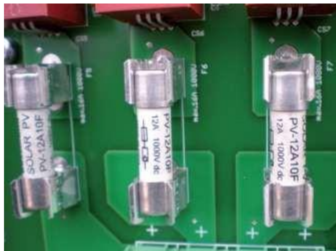
Figura 3-52: Fusibles FV según la norma [Fuente: SIBA]
