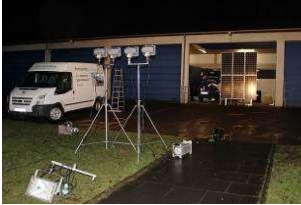
Figura 4-25: Focos halógenos usados por el THW (Agencia Federal de ayuda técnica) de Siegburg alumbrando una construcción compacta de seis módulos.
