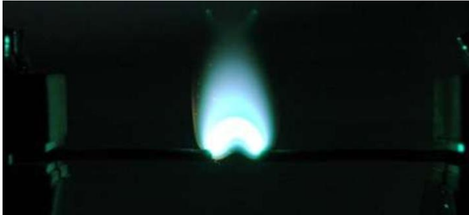
Figura 2-1: Arco eléctrico CC estable entre electrodos de cobre, foto TÜV Rheinland.
