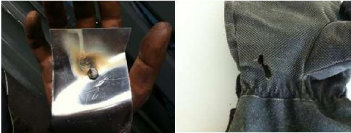
Figura 4-20: Efecto de las corrientes en las superficies de contacto, perforación por quemadura, a causa de la acción de la corriente
