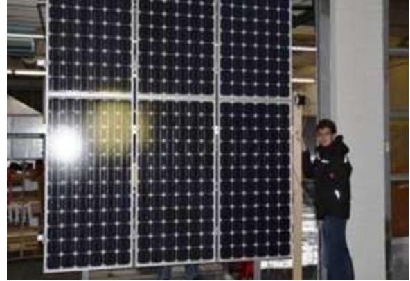
Figura 4-26: Medición, al nivel de módulo, de la radiación recibida desde el reflector (arriba, abajo, lateral y centralmente).
