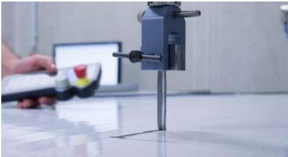
Figura 5-16: Plataforma para probar la fuerza de despegado
