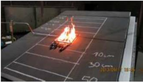
Figura 5-30: Izquierda: Capa de asiento bitumen elastómero, capa de aislación EPS; capa de bloqueo de vapores de bitumen, con nuevo quemador de gas. Derecha: capa aislante de PVC, capa de aislación de lana mineral, capa de bloqueo de humo de bitumen.
