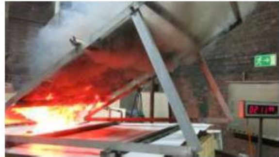
Figura 5-30: Izquierda: Capa de asiento bitumen elastómero, capa de aislación EPS; capa de bloqueo de vapores de bitumen, con nuevo quemador de gas. Derecha: capa aislante de PVC, capa de aislación de lana mineral, capa de bloqueo de humo de bitumen.
