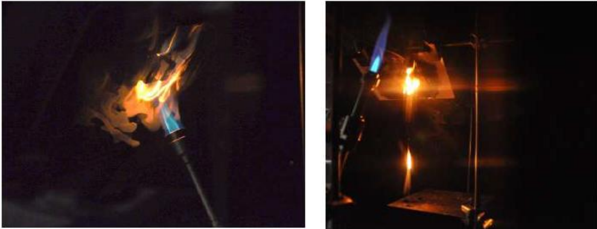
Figura 5-15: Llama aplicada en la cubierta, en la zona de las conexiones de los conductores y flama aplicada en la unión del cable del objeto de prueba. (Fuente: TÜV Rheinland).
