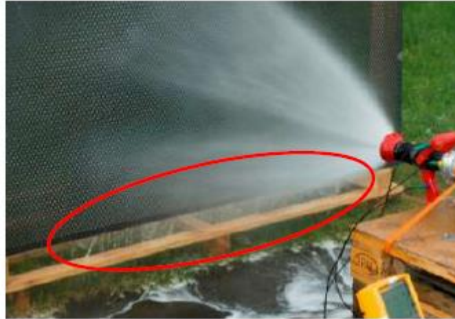
Figura 4-15: El correr del agua forma pistas conductoras al suelo cubierto de agua; aquí chorro de neblina.
