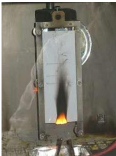
Figura 5-12: Método de prueba para la inflamabilidad según la norma EN 13501-1
