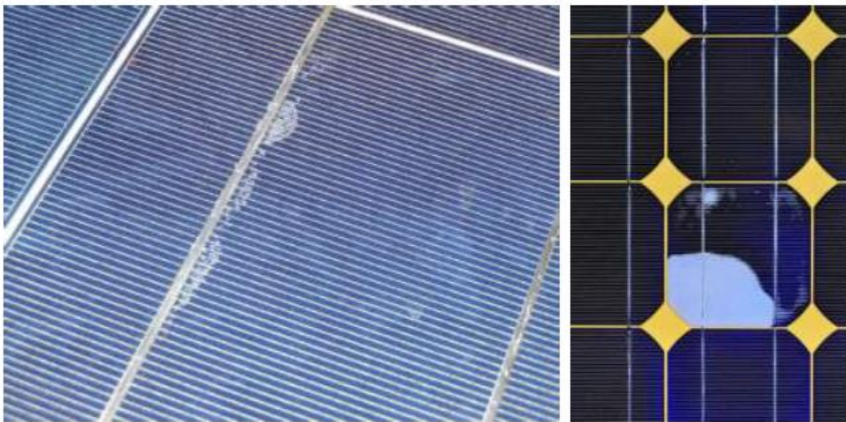
Figura 5-19: Ejemplo de deslaminación cerca de una barra colectora
