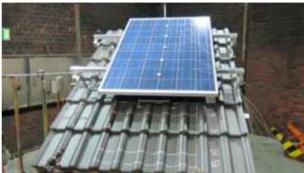
Figura 5-31: Izquierda: Estructura de techo paralelo con tejas de cemento y módulo FV. Derecha: El iniciador de ignición se ubicó entre el módulo y la superficie del techo
