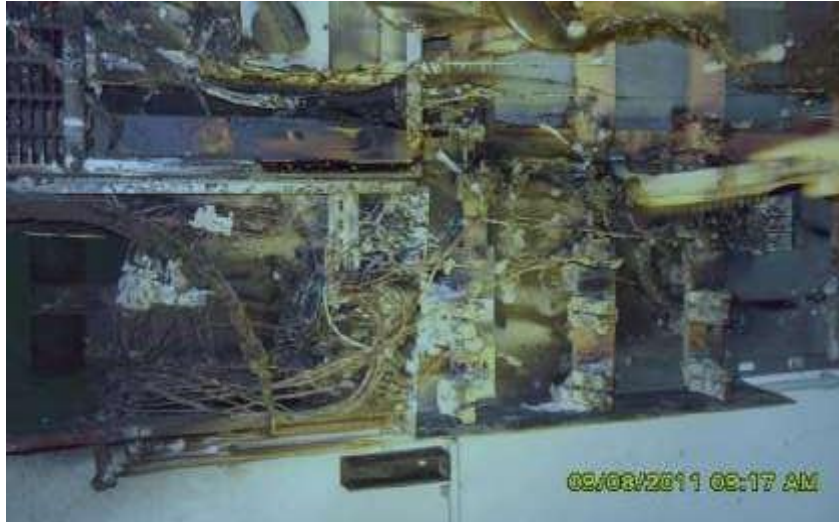
Figura 3-28: Conexión CA de una planta FV quemada (Foto: Uli Motzer, compañía de seguros de Würtemberg)
