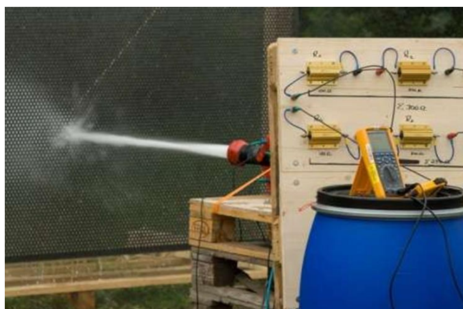
Figura 4-9: Montaje experimental con una resistencia corporal simulada, para la medición de las corrientes de descarga a través del chorro.
