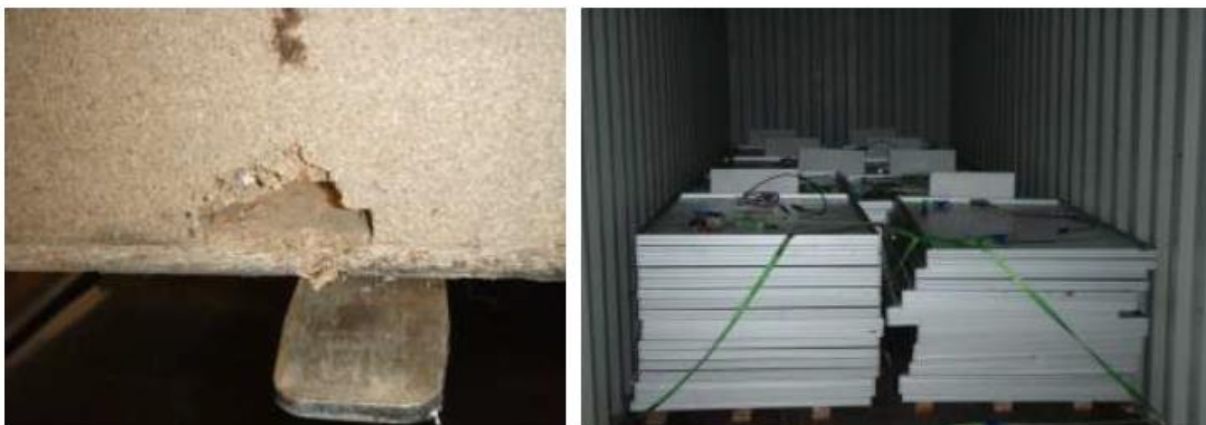
Figura 5-22: Izquierda: Manejo incorrecto con presión de las puntas de la grúa horquilla. Derecha: transporte inadecuado de los módulos solares.
