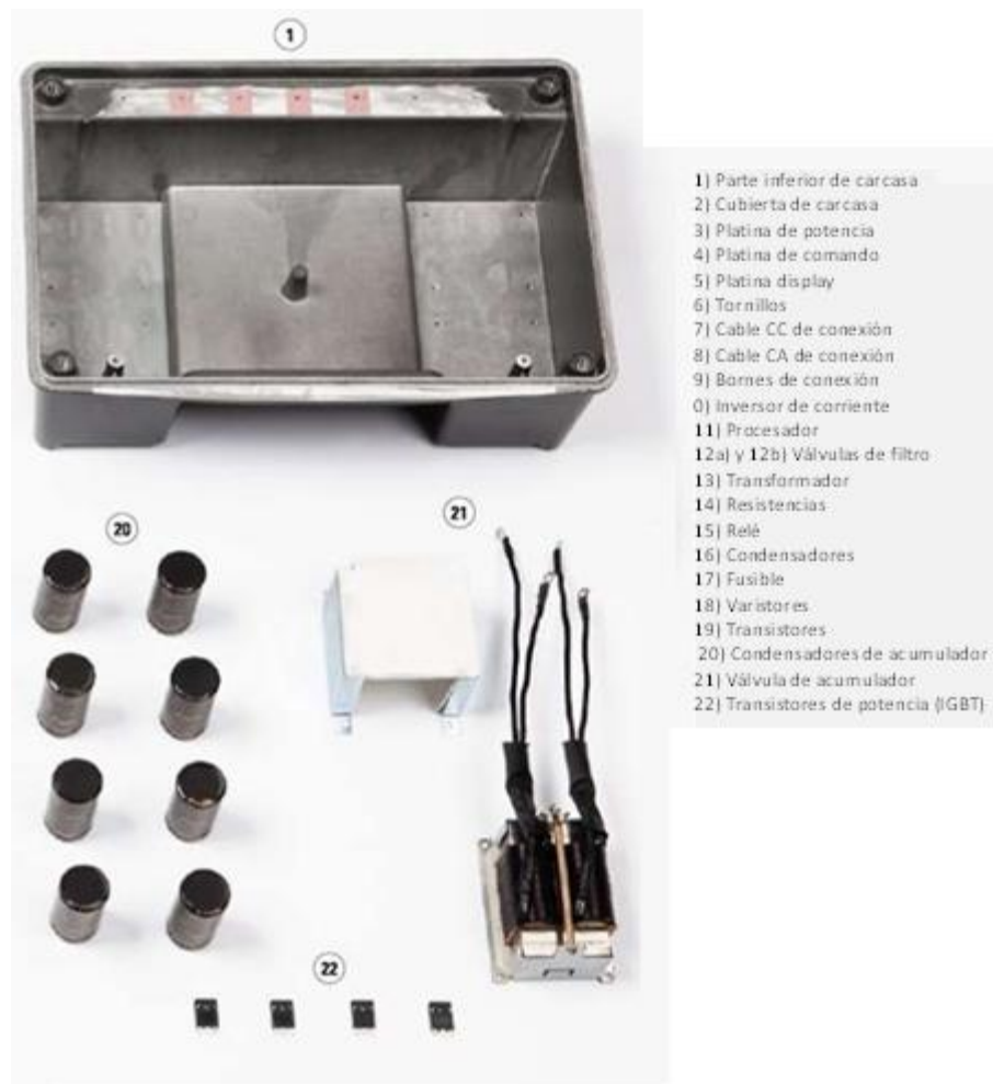
Figura 3-54: Componentes de un inversor de cadena [38]
