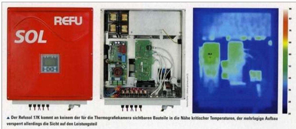
Figura 3-56: Disposición y termografía de un inversor FV de alta eficiencia. Medida máxima de temperatura: 60,4 °C [38]
