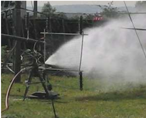
Figura 4-17: Medición de corriente de descarga durante la extinción con espuma, en un sistema eléctrico bajo tensión. Ensayos en terrenos de la OVAG, en 2014, proyecto de cooperación de OVAG Y vfdb.
