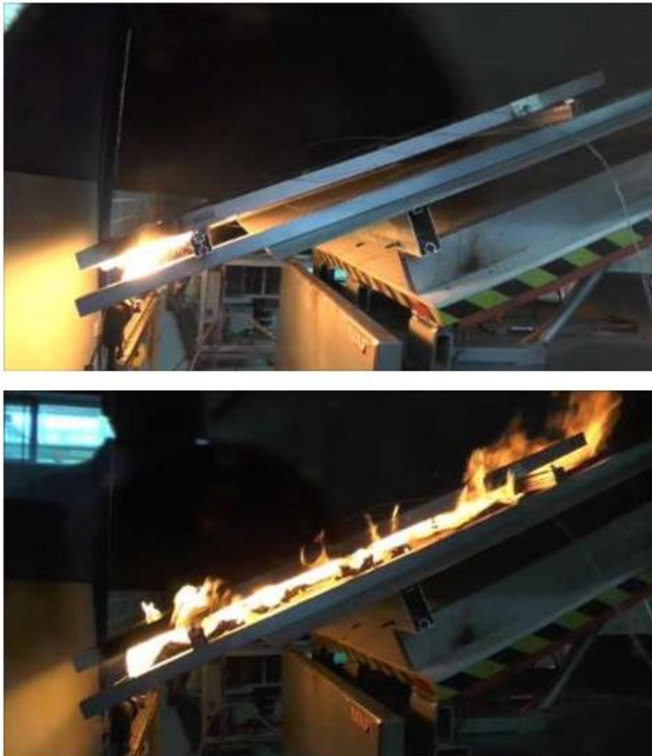
Figura 4-36: Prueba de incendio con una potencia del quemador de 25 kW (arriba) y 150 kW (abajo)
