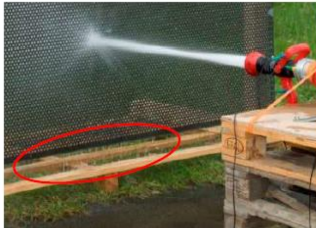
Figura 4-14: El correr del agua forma pistas conductoras al suelo mojado; aquí chorro directo.
