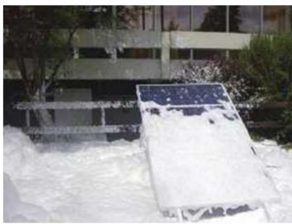
Figura 5-44: Intentos de cobertura opaca de módulos FV, foto: http://pv-notaus.de/gefahren.html
