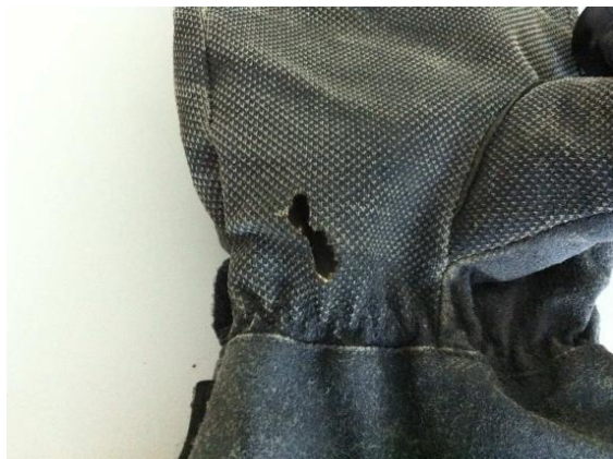
Bild 4-20: Einwirkung der Ströme auf die Kontaktflächen, Brandloch durch Stromeinwirkung
