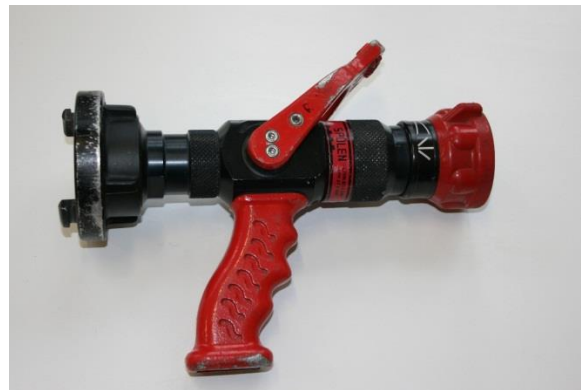
Bild 4-7: C-Hohlstrahlrohr (Quelle: FFW München)
