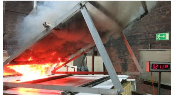
Bild 5-30: Links: Elastomerbitumenunterlagsbahn, EPS-Dämmplatten, Bitumendampfsperrbahn mit neuem Gasbrenner. Rechts: PVC-Dachabdichtungsbahn, Steinwolle Dämmplatten, Bitumendampfsperrbahn
