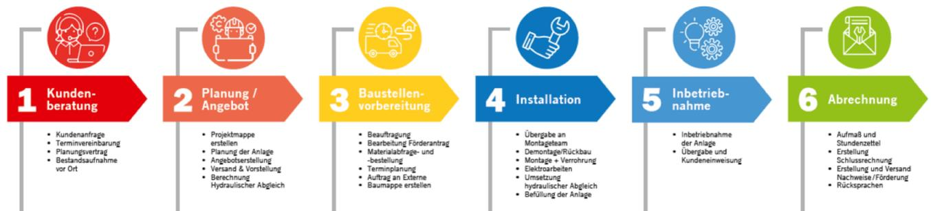
Abbildung 4: Phasen beim Wärmepumpeneinbau. Quelle: ZVSHK
