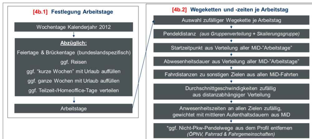
Abbildung 70: Funktionsschema des Arbeitstage-Moduls [4b] des Fahrprofilgenerators
