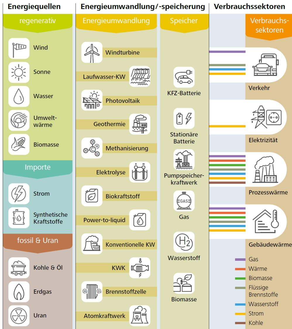
Abbildung 4: Schematische Darstellung des Energiesystemmodells REMod (Quelle: (Sterchele u. a. 2020b))
