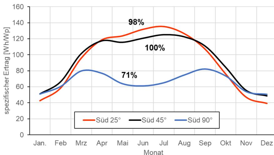
**Abbildung 49: Stomertragsprofile von PV-Kraftwerken in verschiedenen Montagevarianten, berechnet online mit [https://re.jrc.ec.europa.eu/pvg\\_tools](https://re.jrc.ec.europa.eu/pvg_tools), Standort Freiburg, unverschattet; die Prozentzahlen geben den relativen Jahresertrag bezogen auf 45° Neigung an.**
