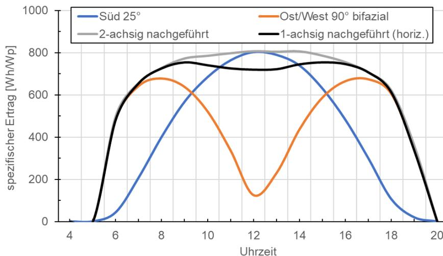
**Abbildung 47: Stromertragsprofile von PV-Kraftwerken in verschiedenen Montagevarianten, berechnet online mit [https://re.jrc.ec.europa.eu/pvg\\_tools](https://re.jrc.ec.europa.eu/pvg_tools) für einen überwiegend klaren Maitag am Standort Freiburg, ohne Verschattungseffekte, Bifazialitätsfaktor 100%.**
