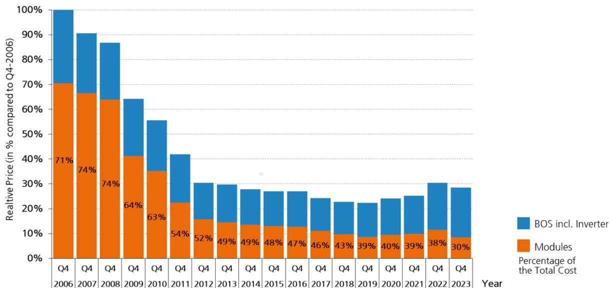
**Abbildung 5: Entwicklung des durchschnittlichen Endkundenpreises (Systempreis, netto) für fertig installierte Aufdachanlagen von 10 – 100 kW<sub>p</sub>, Daten: BSW [ISE5].**
