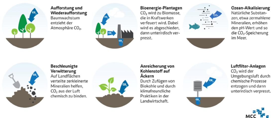
**Abbildung 9: Verfahren zur Entnahme von CO<sub>2</sub> aus der Atmosphäre und Einlagerung von Kohlenstoff [MCC].**
