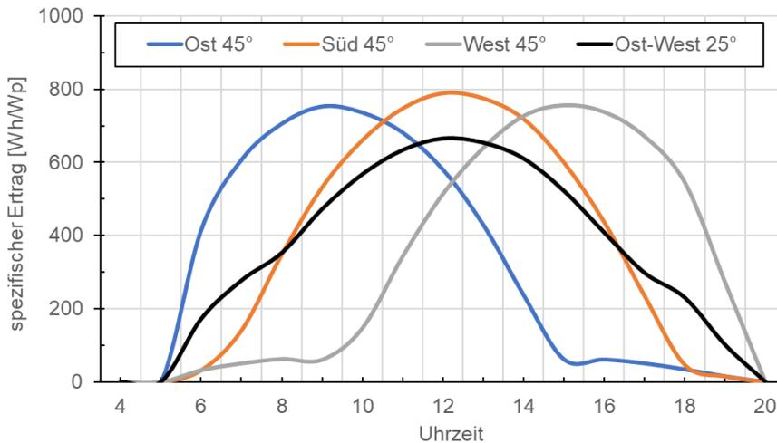
**Abbildung 48: Stomertragsprofile von PV-Kraftwerken in verschiedenen Montagevarianten, berechnet online mit [https://re.jrc.ec.europa.eu/pvg\\_tools](https://re.jrc.ec.europa.eu/pvg_tools) für einen überwiegend klaren Maitag am Standort Freiburg, unverschattet.**
