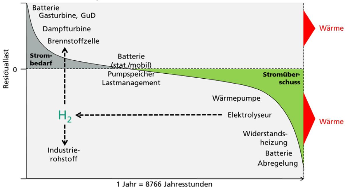
**Abbildung 45: Schematische Darstellung einer Residuallastkurve für Deutschland bei Stromversorgung mit 100 % EE.**
