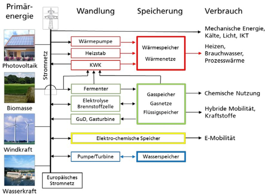
**Abbildung 56: Vereinfachte schematische Darstellung eines Erneuerbaren Energiesystems mit den wichtigsten stromnetzgebundenen Bausteinen der Gewinnung, Wandlung, Speicherung und des Verbrauchs; IKT: Informations- und Kommunikationstechnik, KWK: Kraft-Wärme-Kopplung, GuD: Gas-und-Dampf-Kombikraftwerk.**
