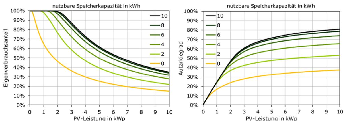
**Abbildung 51: Einfluss der Photovoltaikleistung und Speicherkapazität auf den Eigenverbrauchsanteil (links) und Autarkiegrad (rechts) bei einem Jahresstrombedarf von 4000 kWh [HTW].**
