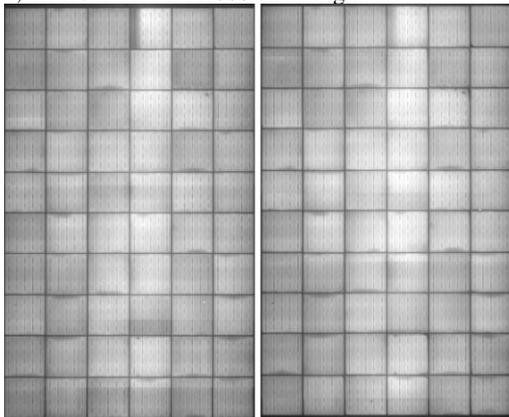
Figure 8: 60 cell module before and after DH1000
