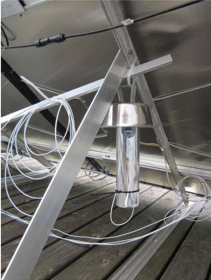
Umgebungslufttemperatursensor mit Strahlungsschutz und Bewicklung
