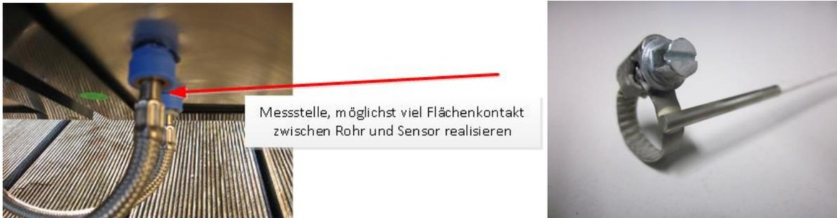
Abbildung 29: Dargestellt ist eine Messstelle mit besonderen Anforderungen am Fluidkreislauf-Anschluss eines PVT-Moduls, das Teil des PVT-Kollektorfelds des Testsystems bildet (links). Rechts ist ein speziell auf die Anforderungen zugeschnittener Anlegefühler.
