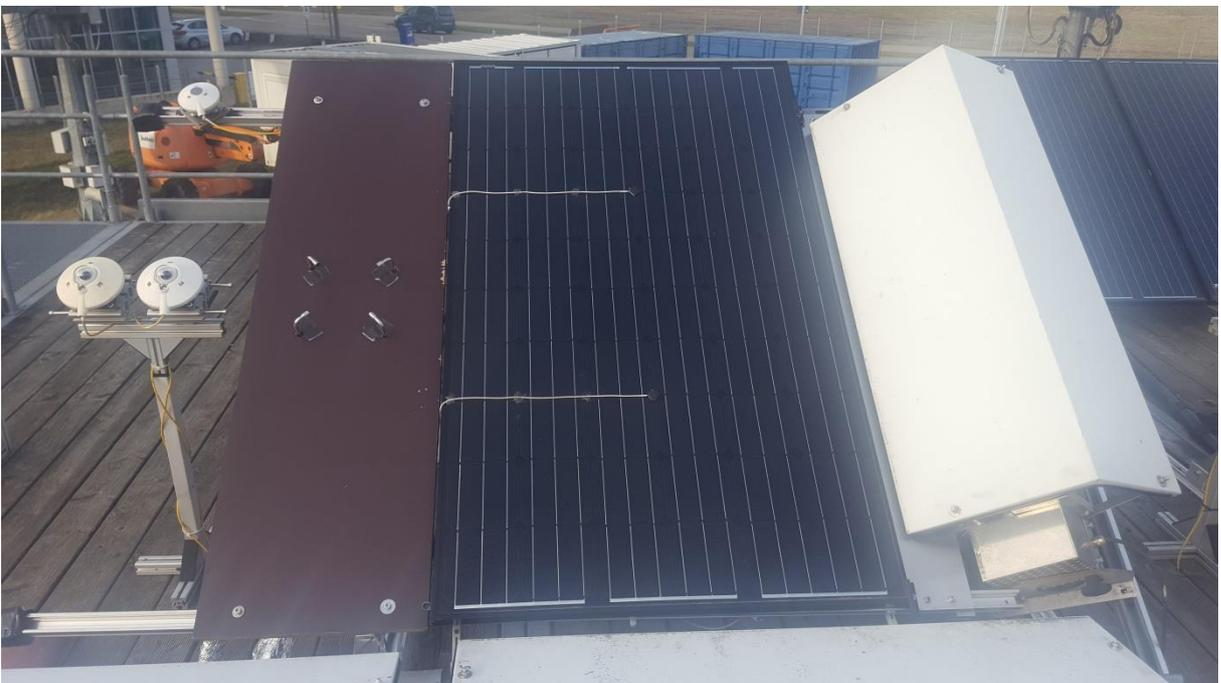
Abbildung 20: PVT-Modul – rückseitig isoliert während der Messung.
