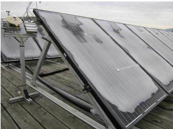
Oberflächen-Anlegetemperatursensoren (auf der Abdeckung)
