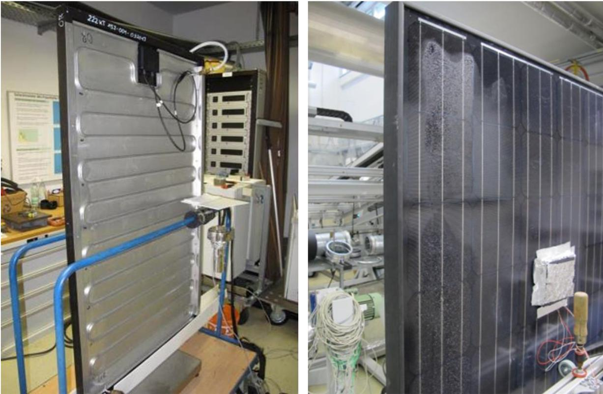
Abbildung 3: Gezeigt wird der Messaufbau für den Vorversuch mit PVT-Kollektor auf einer hochgenauen Waage während der Messung. Auf dem linken Foto ist Kondensat auf der Kollektoroberfläche erkennbar.
