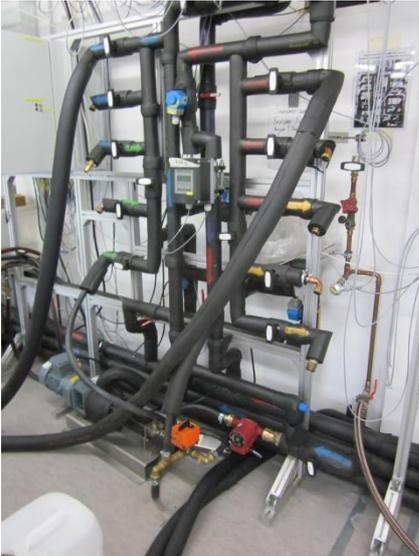
Hydraulikverschaltung für Heizungsemulation
