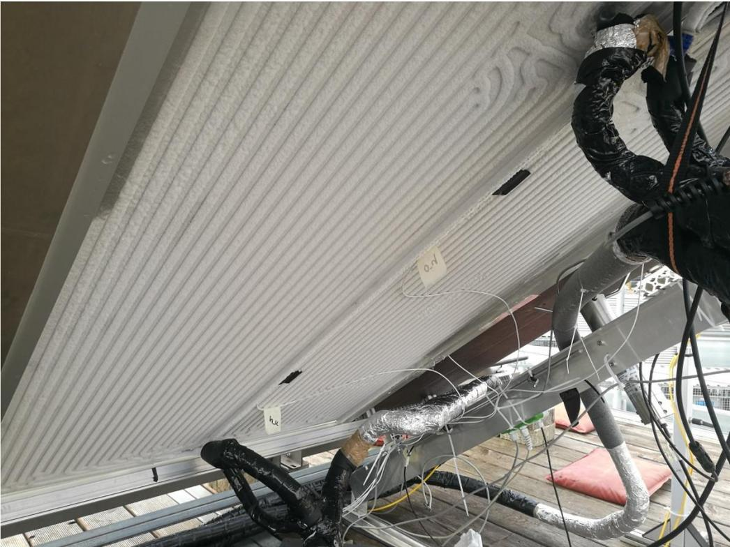
Abbildung 21: PVT-Modul – ohne rückseitige Wärmedämmung während der Messung – Rückseite vereist
