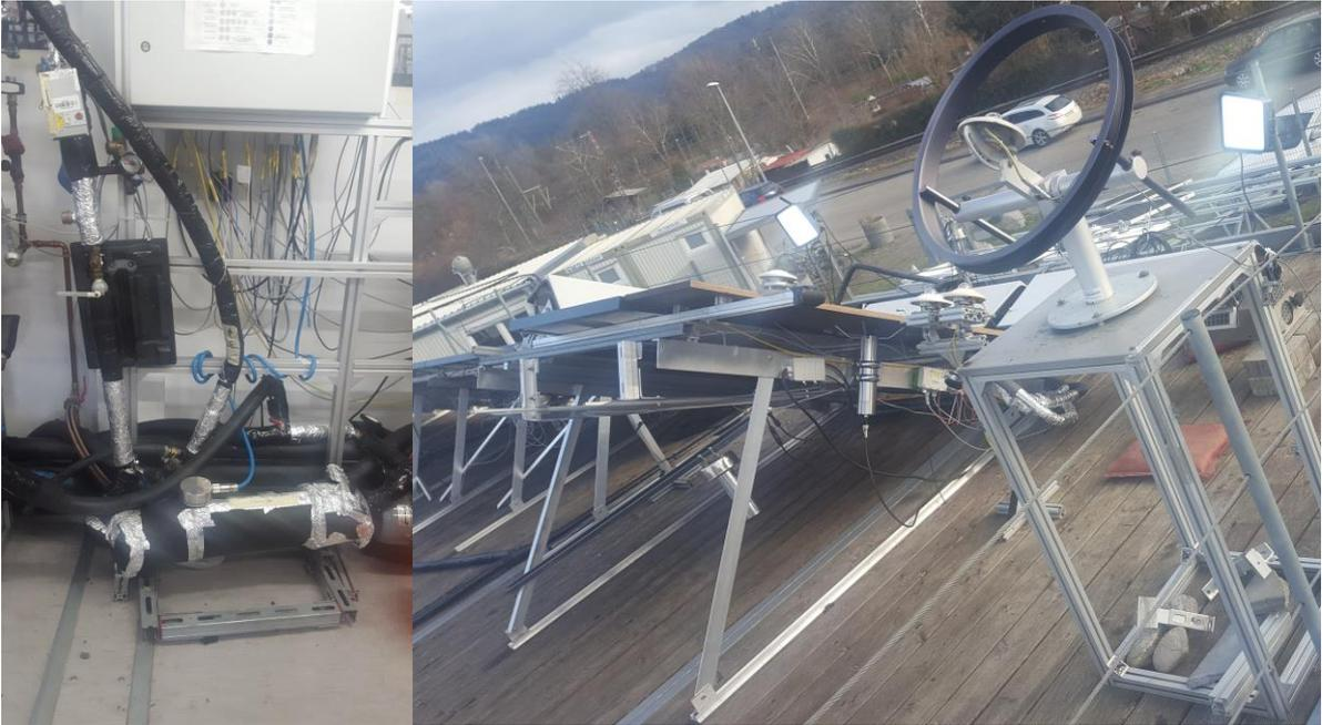
Abbildung 19: Hydraulik der Einzelmodul-Messungen am Außenprüfstand.
