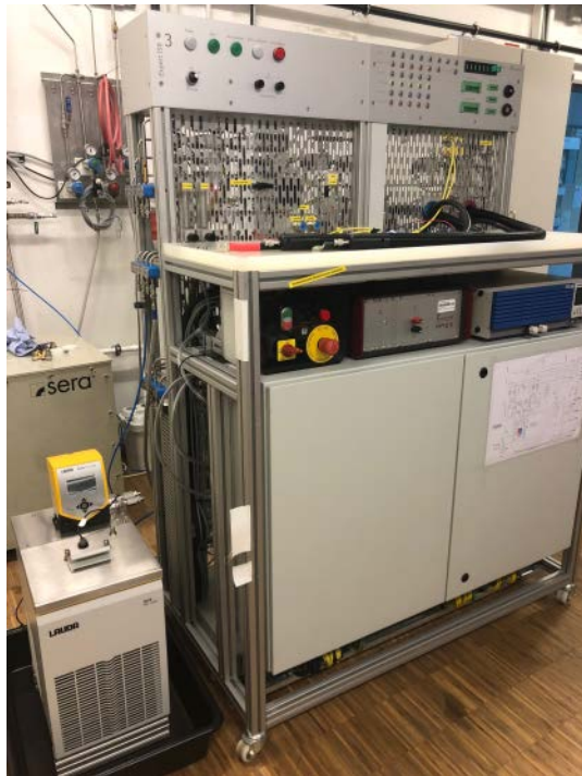
Abb. 01: Neue Generation von Einzelzell-Testständen des Fraunhofer ISE
