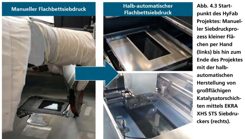
**Abb. 4.3** Startpunkt des HyFab Projektes: Manueller Siebdruckprozess kleiner Flächen per Hand (links) bis hin zum Ende des Projektes mit der halb-automatischen Herstellung von großflächigen Katalysatorschichten mittels EKRA XHS STS Siebdruckers (rechts).
