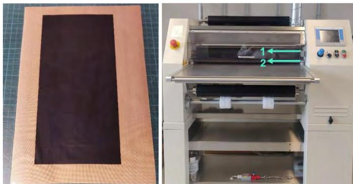
**Abb. 4.25 Links: Fertig hergestellte CCM nach dem Transferprozess für den generischen Stack. Die braune Decalfolie dient nur als Unterlage. Rechts: Rollen-Laminator zum Transfer von großflächigen Kathoden und Anoden auf die Membran**
