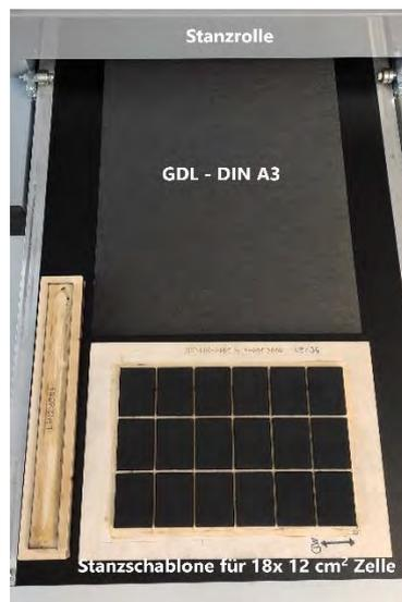
**Abb. 5.1 Stanzvorrichtung für Gasdiffusionslagen**
