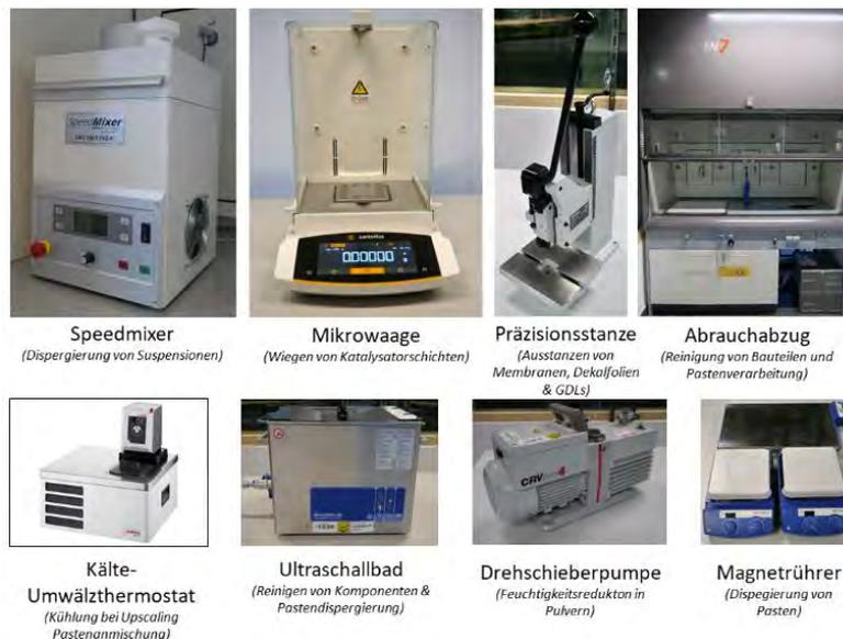
**Abb. 4.7 Geräte zur Produktion von Katalysatorschichten, welche im Rahmen HyFab bereits geliefert und in Betrieb genommen wurden.**
