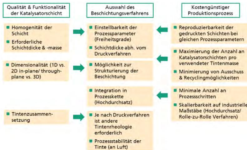
**Abb. 4.1 Übersicht über die Anforderungen an einen Beschichtungsprozess**
