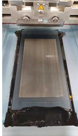
**Abb. 4.20 Erfolgreiche Druckversuche zur Herstellung der vergrößerten aktiven Fläche im Vergleich zu den herkömmlichen 20cm<sup>2</sup> (links). Eine größere Pastenmenge wird verwendet (rechts).**
