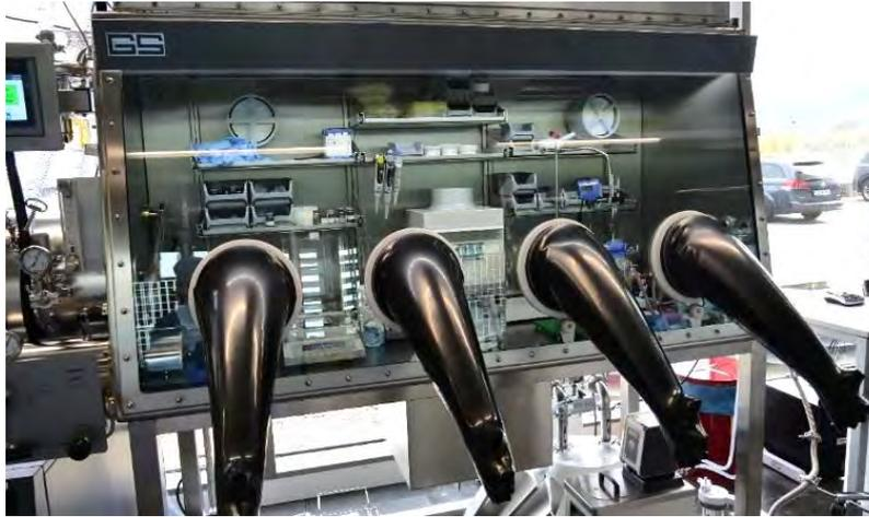
**Abb. 4.6 Glovebox-System zur Herstellung von Katalysator-tinten in einer inerten Atmosphäre**
