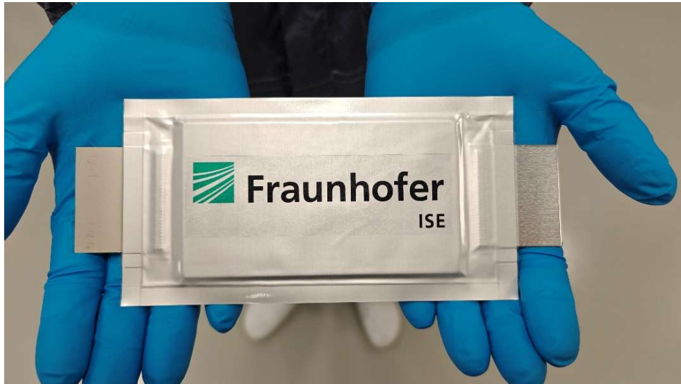
Abb. 2: Pouch-Zelle, hergestellt in der Fertigungslinie des Fraunhofer ISE. © Fraunhofer ISE
