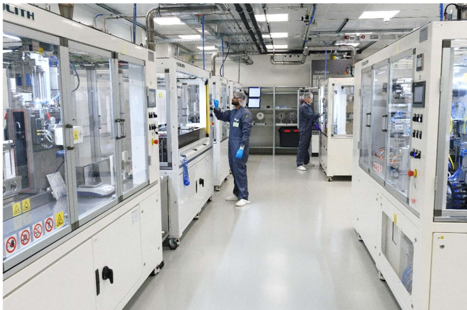
Abb. 3: Halbautomatische Fertigungslinie für industriennahe Pouch-Zellen im Trockenraum des Fraunhofer ISE im Zentrum für Elektrische Energiespeicher. © Fraunhofer ISE
