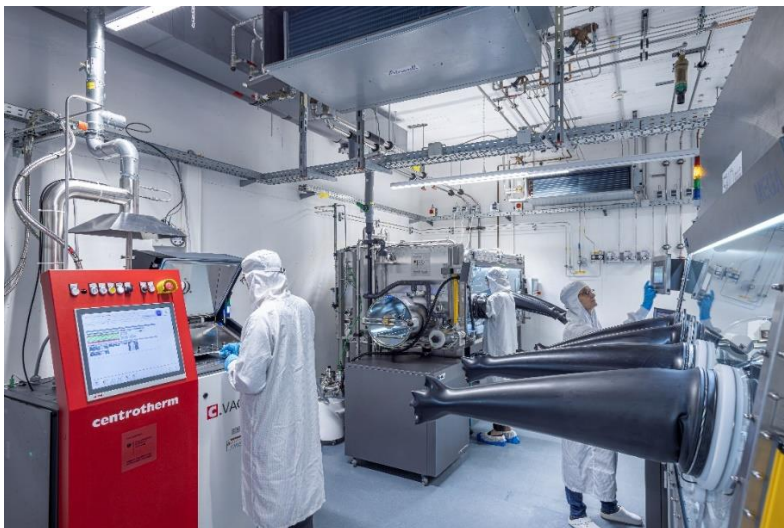
Abb. 3 Das Fraunhofer ISE setzt beim Herstellungsverfahren für Perowskit-Silizium-Tandemsolarzellen auf die sogenannte »Hybrid-Route«, der Kombination von Vakuum- und nass-chemischen Prozessen. © Fraunhofer ISE / Foto: Michael Spiegelhalter
