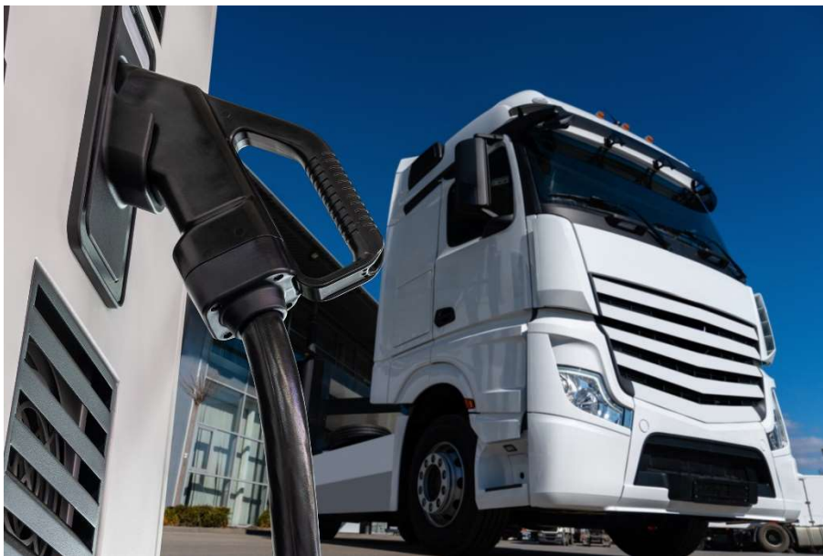
Die höheren Ladeleistungen für LKW stellen die Leistungselektronik und das Kontaktsystem von Ladestationen und auch die verfügbare Netzanschlusskapazität vor neue Herausforderungen. ©Stock.adobe.com/Evgeniy & Karina Gerasimovi
