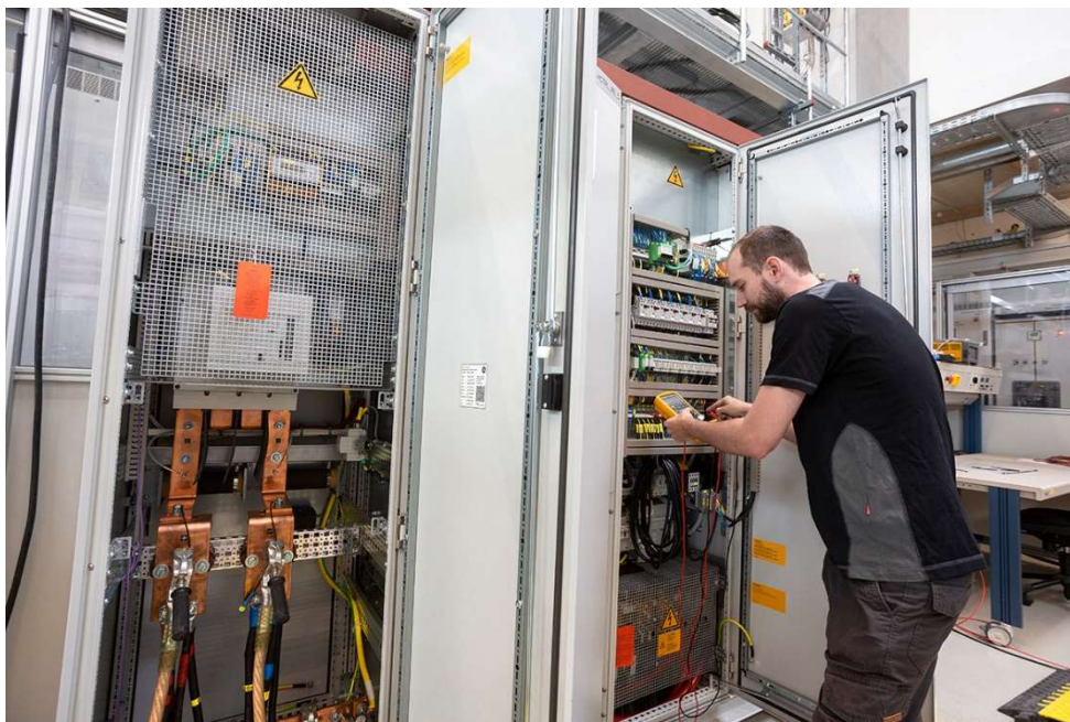
Vorbereitung eines netzbildenden Wechselrichters für die Vermessung im Multi-Megawatt Lab des Fraunhofer ISE. © Fraunhofer ISE
