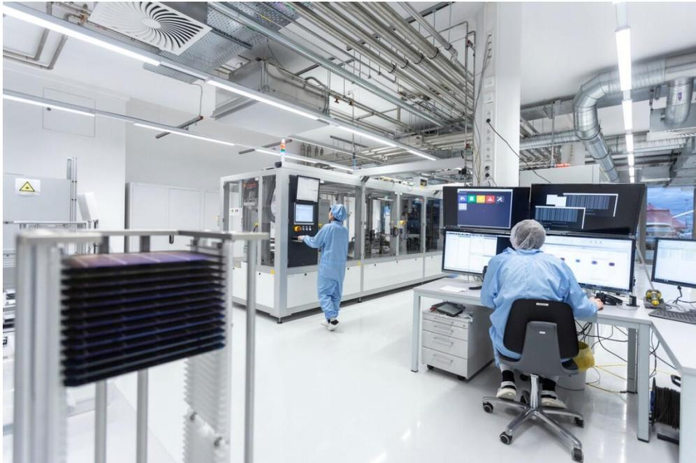
**Abb. 1** Automatisierter Inline-Solarzellen-Tester im PV-TEC mit Leitrechner für fortschrittliche Auswertung der Messdaten. Für rückseitenkontaktierte Solarzellen wäre ein kontaktloses Testverfahren vorteilhaft. © Fraunhofer ISE/Foto: Dirk Mahler
