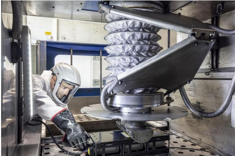
Im Labor für Batterietests können auch zerstörende Tests wie hier mit der Abuse-Press durchgeführt werden. ©Fraunhofer ISE
