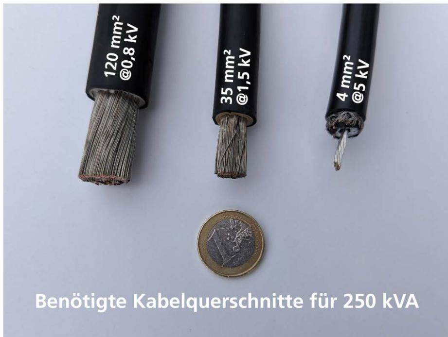
Reduktion der Kabelquerschnitte durch höhere Spannung. © Fraunhofer ISE
