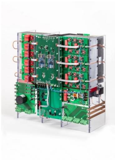
**Der vom Fraunhofer ISE entwickelte Wechselrichter ermöglicht der Photovoltaik den Sprung von der Nieder- in die Mittelspannung. © Fraunhofer ISE**
