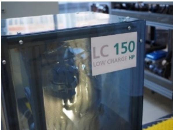
Die Wärmepumpe mit dem klimafreundlichen Kältemittel Propan aus dem Projekt »LC150«. ©: Fraunhofer ISE
