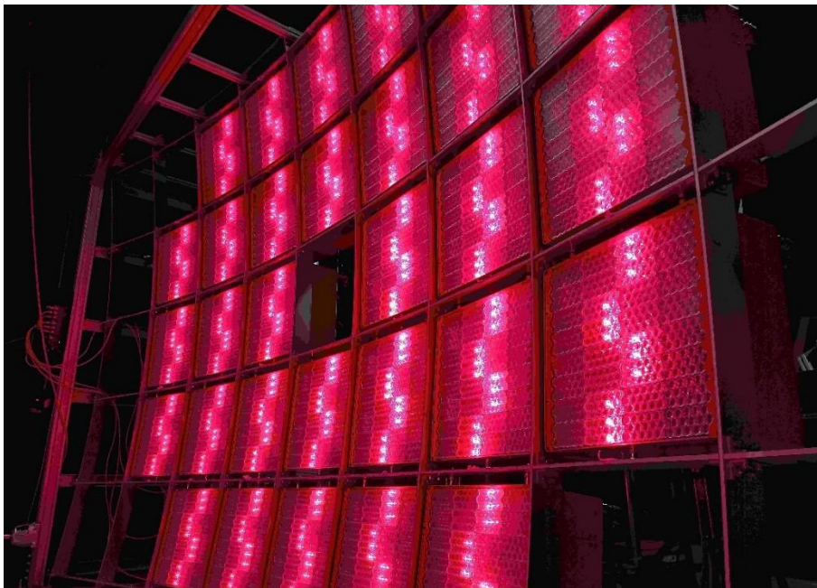
Der Sonnensimulator verfügt über 28 unterschiedliche spektral einstellbare Lichtkanäle, verteilt auf 40 Lichtquellen mit insgesamt 18400 LEDs © Fraunhofer ISE
