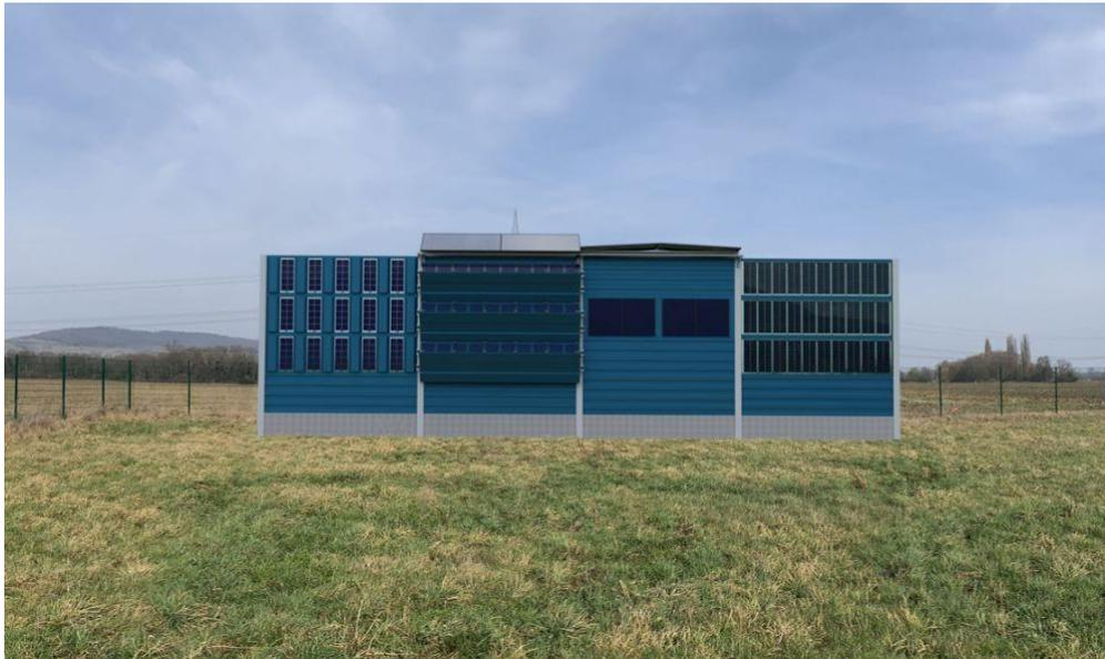
**Rendering der fünf Konzepte an vier PV-Lärmschutzwandelementen, die aktuell auf dem Outdoor Performance Testfeld des Fraunhofer ISE aufgebaut werden.**
