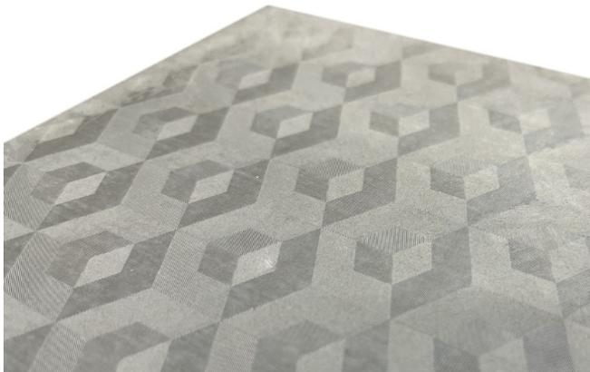
Ultrahochleistungsbeton-Muster mit Oberflächenstrukturen. ©Fraunhofer ISE
