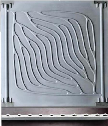
Rückseite eines TABSOLAR®-Elements mit bionischer FracTherm®-Kanalstruktur, seitlichen Sammelkanälen und Hydraulikanschlussbuchsen (oben) sowie Schnitt durch ein TABSOLAR®-Element (unten). © G.tecz Engineering GmbH
