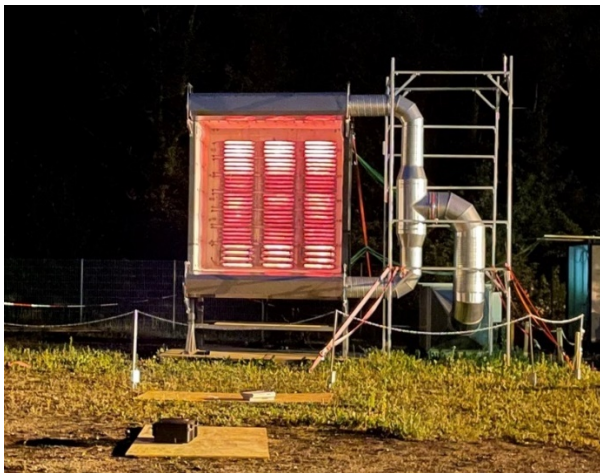
Die Luftwand wurde in einem Receiver-Testaufbau im Realmaßstab erprobt und optimiert. © Fraunhofer ISE
