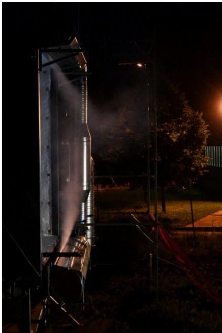
Ein Luftstrom trennt das heiße Innere des Receivers (links) von der Außenluft. © Fraunhofer ISE
