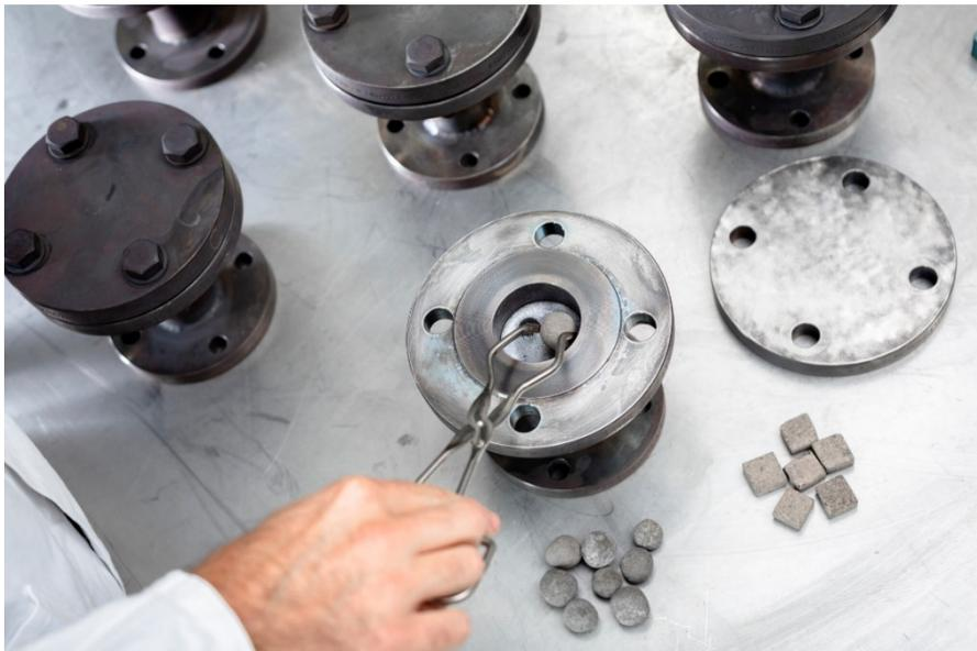
In Auslagerungstest wurde die Kompatibilität zwischen Füllkörpern und verschiedenen Fluiden überprüft. Die unterschiedlichen Geometrien dienen zur Überprüfung der mechanischen Stabilität vor und nach den Tests.
