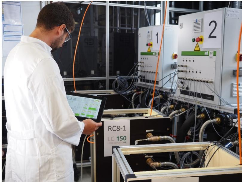
Im Projekt »LCR290« wird auf Ergebnisse des Projekts »LC150« zurückgegriffen, um die Kältemittelreduktion auf größere Leistungen zu übertragen. © Fraunhofer ISE
