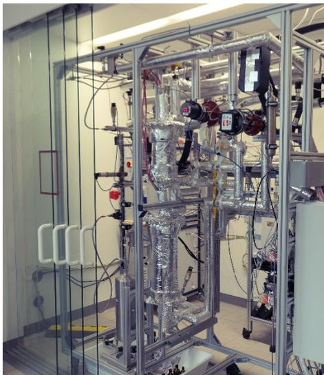
In der Miniplant wurde die Methanolsynthese aus Hüttengasen erfolgreich demonstriert. ©Fraunhofer ISE
