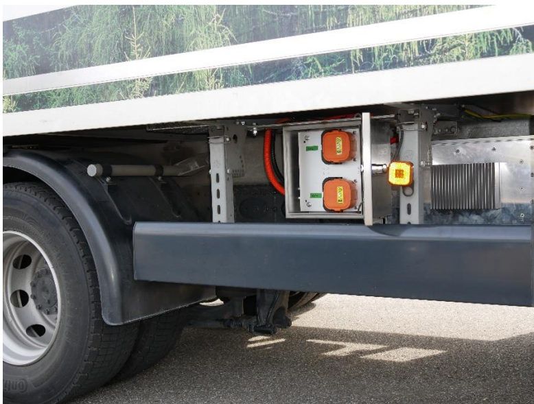
Der Gleichstromsteller sitzt platzsparend unter dem LKW-Koffer. © Fraunhofer ISE
