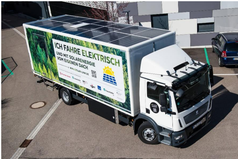
Die in den Kofferaufbau integrierten Solarmodule nutzen das gesamte Dach vollständig aus. © Fraunhofer ISE
