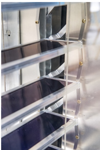
Die Lamellen der solarthermischen Jalousie dienen als Absorber. Die Wärme wird über Heat-Pipes und einen Aluminiumadapter an den Sammelkanal abgeführt. ©Fraunhofer ISE
