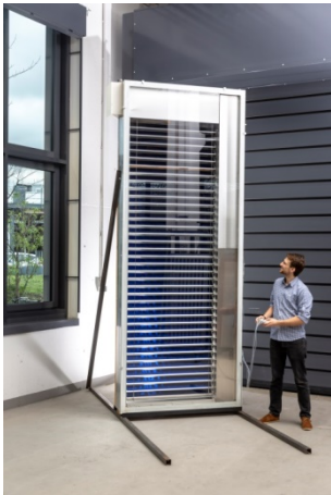
Die Jalousie ist insbesondere für Gebäude mit großen Glasfassaden geeignet. Der Demonstrator der Solarthermischen Jalousie ist in ein Doppelfassadenelement integriert. ©Fraunhofer ISE
