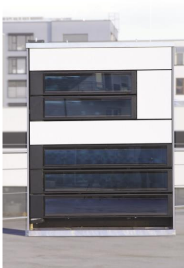
Die Streifenkollektoren können in unterschiedlichen Längen ausgeführt werden. ©Fraunhofer ISE
