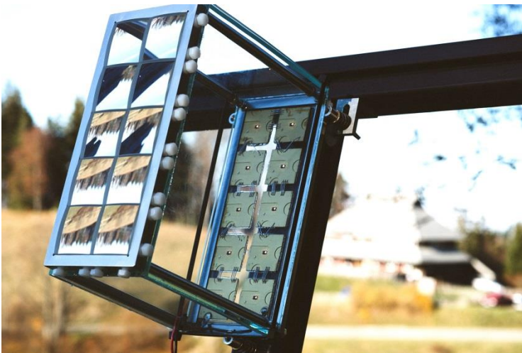
Konzentrator-Photovoltaikmodul mit höchster Effizienz: 41,4% der Solareinstrahlung wird in elektrische Energie gewandelt. © Fraunhofer ISE
