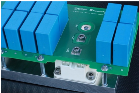
Leistungsstack, bestehend aus einem Flüssigkeitskühler, Siliciumkarbid-MOSFET-Modul, Hochstromplatine und Folienkondensatoren. ©Fraunhofer ISE
