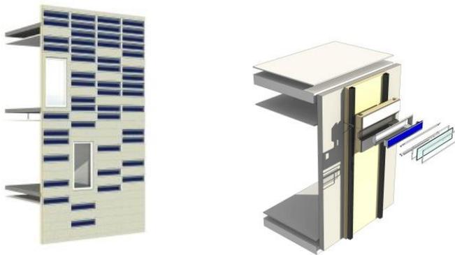
Visualisierung einer Fassade mit Streifenkollektoren und schematischer Aufbau eines Kollektorstreifens. ©Facade-Lab
