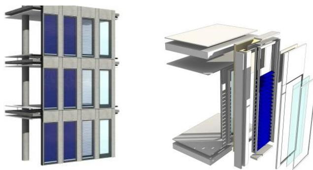
Visualisierung einer Fassade mit solarthermischer Jalousie und schematischer Aufbau einer solchen Jalousie mit einem vertikalen Sammelkanal. ©Facade-Lab
