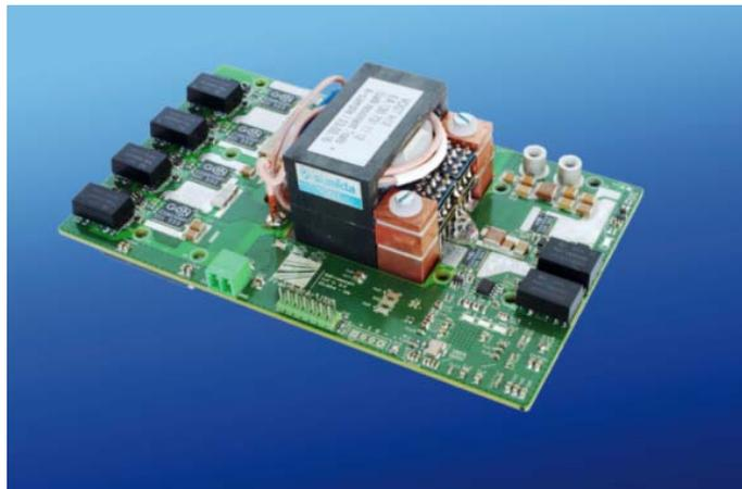
Neue Materialien ermöglichen hohe Taktfrequenzen: Fraunhofer ISE entwickelt resonanten DC/DC-Wandler (Demonstrator) mit 2,5 MHz für die Luftfahrtanwendung. ©Fraunhofer ISE
