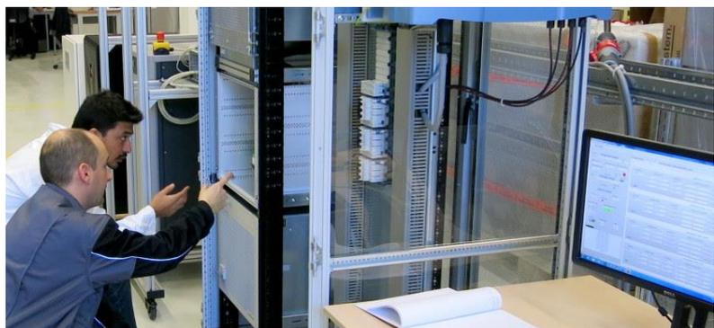
Teststand für PV-Heimspeichersysteme am Fraunhofer ISE: Vor dem Start der Batterietests werden das Set-Up sowie alle notwendigen Prozessschritte noch einmal geprüft. ©Fraunhofer ISE
