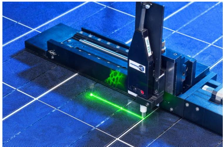
Ramanspektroskopische Messung eines PV-Moduls am Fraunhofer ISE.
