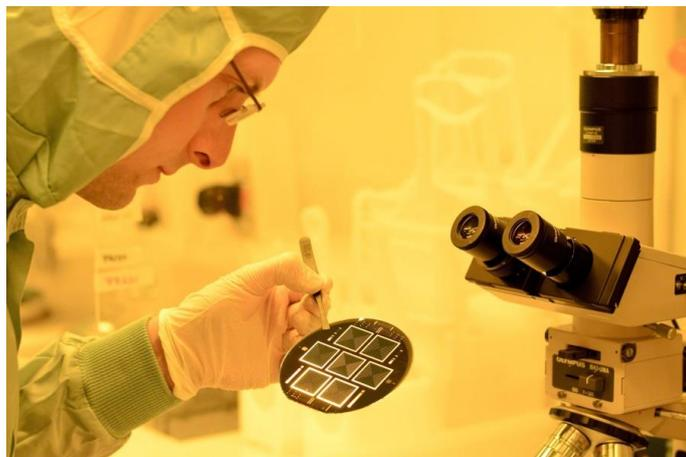
Fraunhofer ISE erzielt neuen Weltrekord für beidseitig kontaktierte Siliciumsolarzellen: TOPCon-Technologie ermöglicht 25,1 Prozent Wirkungsgrad. ©Fraunhofer ISE
