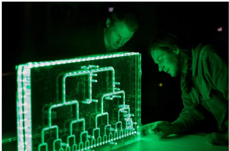
Vermessung einer neuartigen Verteilerstruktur für Kältemittelverdampfer.
