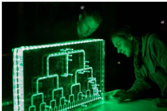
Vermessung einer Verteilerstruktur für Kältemittelverdampfer.
