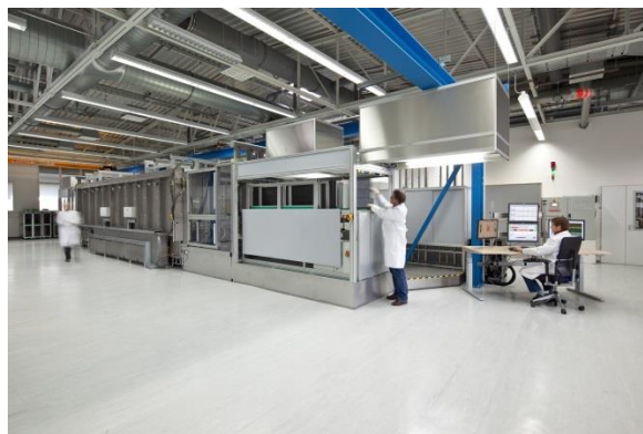
ProConCVD Anlage zur Herstellung von epitaktischen Wafern mittels Epitaxie. ©Fraunhofer ISE
