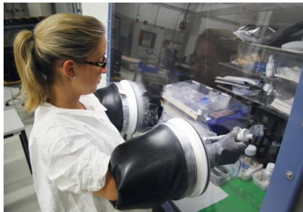
Mitarbeiterin des Fraunhofer ISE an der Glovebox bei der Elektrolytbefüllung von Lithium-Ionen-Zellen vor der elektrischen Formierung. ©Fraunhofer ISE
