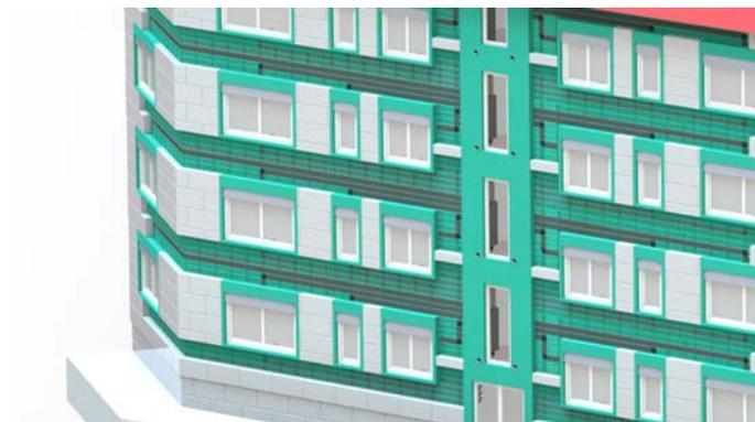
Integration von Leitungen und Rohren in die Fassade eines Demonstrationsgebäudes in Frankfurt aus den 1950er Jahren. ©Fraunhofer ISE
