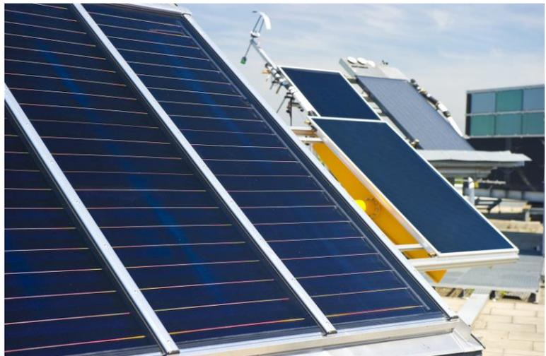
Außenteststand des TestLab Solar Thermal Systems am Fraunhofer ISE. Die Experten des Testlabors haben bereits weit über 500 Kollektoren und Anlagen vermessen und charakterisiert. Darüber hinaus engagieren sie sich bei der Entwicklung von Richtlinien, Normen und in der Gremienarbeit, z. B. für das Energy Label. ©Fraunhofer ISE
