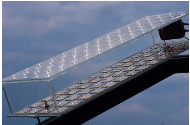
FLATCON ® -Konzentratormodul mit einem Wirkungsgrad von 36,7 %. ©Fraunhofer ISE, Foto Alexander Weckeli
