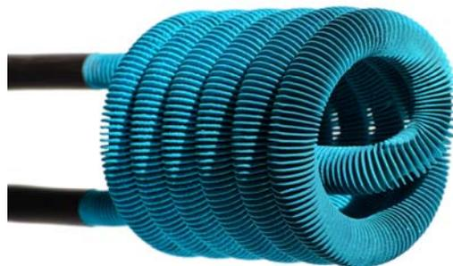
Anwendung von hochporösen Metallorganischen Gerüstverbindungen (MOFs): Rippenrohrwärmetauscher mit einer Direktaufkristallisation von Kupfertrimesat. ©Fraunhofer ISE
