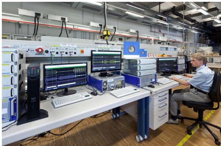
Hochauflösendes Messsystem zur detaillierten Analyse des elektrischen Verhaltens von Solarparks. Das System ermöglicht die zeitsynchrone Erfassung der Ströme und Spannungen von mehreren räumlich verteilten Solarwechselrichtern. ©Fraunhofer ISE
