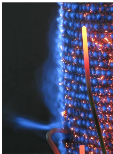
Mit Öldampf betriebener Gasbrenner. ©Fraunhofer ISE
