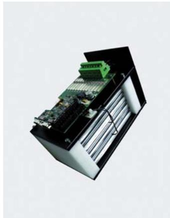
Lithium-Ionen-Batteriemodul mit (elektronischem) Batteriemangement. Das Fraunhofer ISE entwickelt Speichersysteme für Solarstrom, deren Lebensdauer jener von Photovoltaikanlagen angepasst ist. ©Fraunhofer ISE
