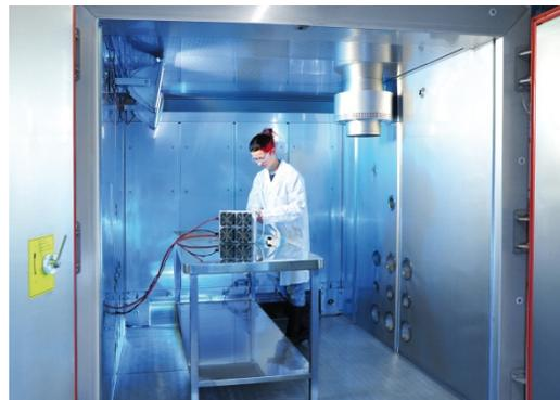
Begehbare Klimakammer für den Test von Brennstoffzellenstapeln und -systemen.
